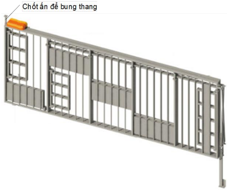
Hình A.19 – Ví dụ minh họa thang thoát nạn khẩn cấp tích hợp lan can tự hạ ở mặt ngoài nhà (trạng thái đóng của một phân đoạn thang trong phạm vi 1 tầng)
